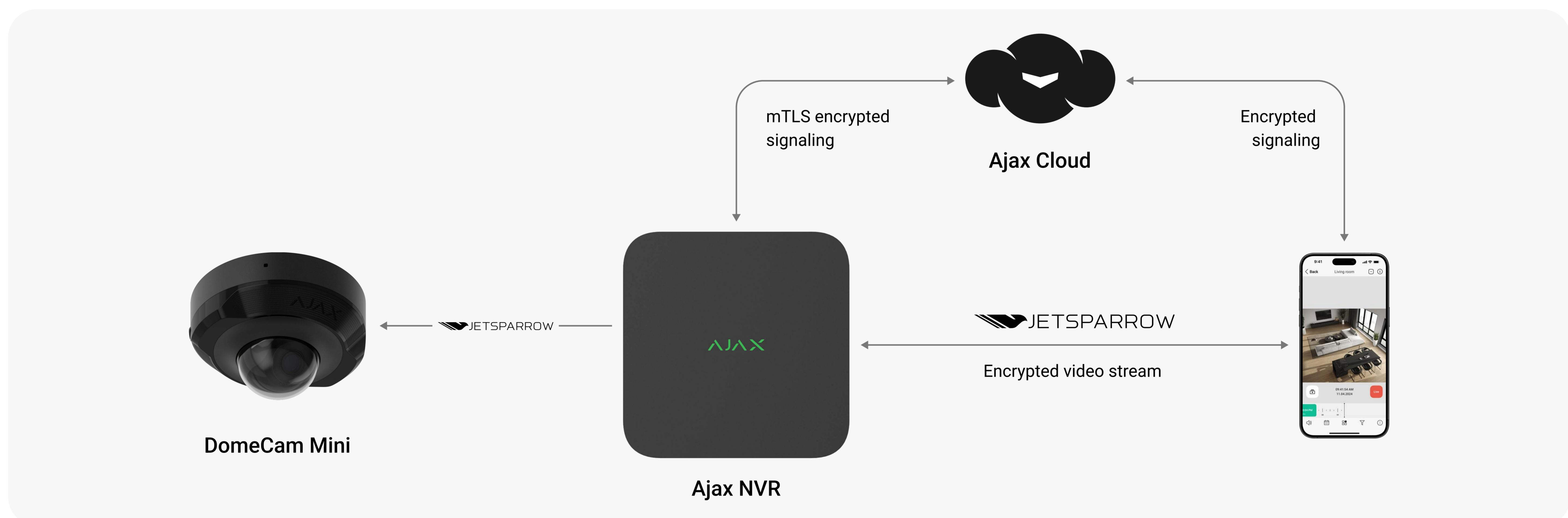
DomeCam Mini kann ohne Ajax NVR arbeiten und speichert das Archiv auf der SD-Karte (falls installiert)
