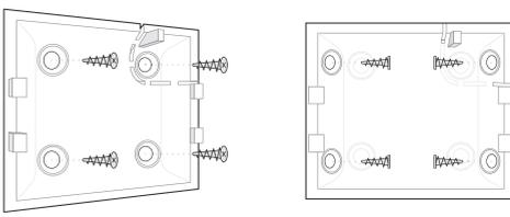
2. Platzieren Sie den Sensor auf der Platte – das einmalige Blinken der Leuchtdiode bestätigt, dass der Sabotagekontakt aktiviert wurde.
